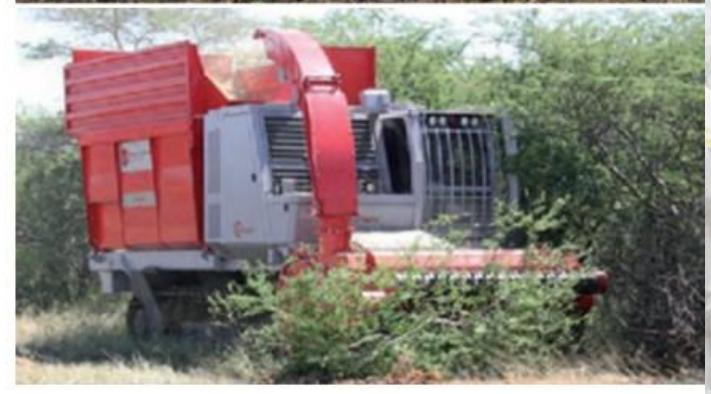
**Cabezal desbrozador recolector propulsadas por tractor**
