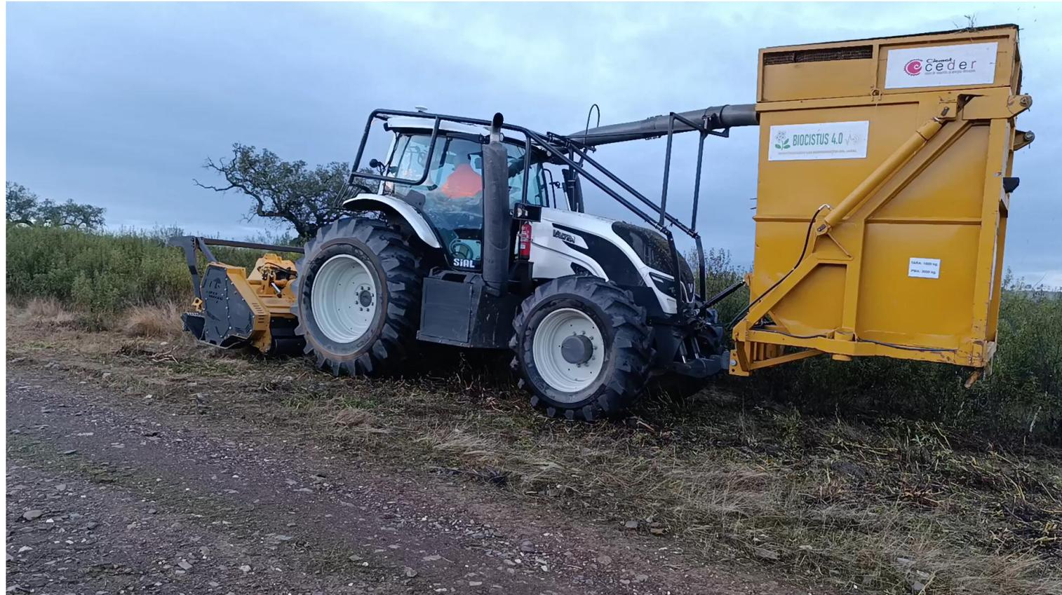
Tractor Valtra T194D (200 CV) con desbrozadora-trituradora López-Garrido TBA 2300 y contenedor para biomasa (5 m<sup>3</sup>)
